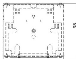
Abmessung (B x H x T), 61 x 115 x 113mm
